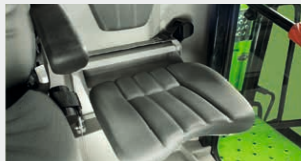
3) ПАССАЖИРСКОЕ МЕСТО Складывается для оптимального использования пространства в кабине.
