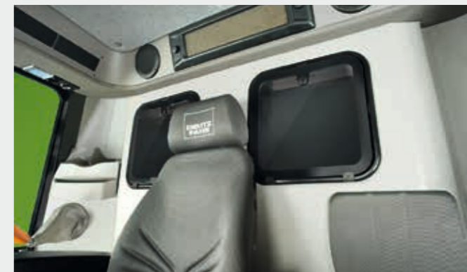
↑ Визуальный контроль зернового бункера. Двойное окно в кабине позволяет оператору визуально контролировать уровень заполнения бункера и качество собранного зерна.
