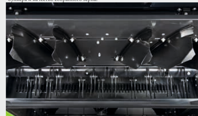
↑ Измельчитель соломы, для еще более эффективного распределения материала, измельчитель соломы также может быть оснащен дефлекторами, электрически регулируемые из кабины, для регулировки разбрасывания в зависимости от погодных условий.
