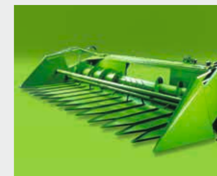
Комплект для уборки подсолнечника убирает только головки подсолнечника для оптимальной уборки.
