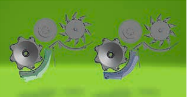
РЕГУЛИРОВКА ЗАЗОРОВ ПОДБАРАБАНЫЯ. Зазор между подбарабаньями и молотильным барабаном на входе и выходе можно независимо регулировать спереди и сзади с помощью электроприводов, управляемых системой Commander Control.
