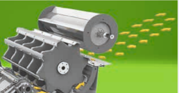
МОЛОТИЛЬНЫЙ БАРАБАН, РЕШЕТО И СОЛОМОРАЗБРАСЫВАТЕЛЬ. Широкий молотильный барабан диаметром 600 мм и шириной 1,27 м для модели с 5 соломотрясами и 1,52 м в ширину для модели с 6 соломотрясами, а также многосегментное подбарабанье с углом наклона 121 ° обеспечивают идеальные результаты обмолота в любых условиях.
