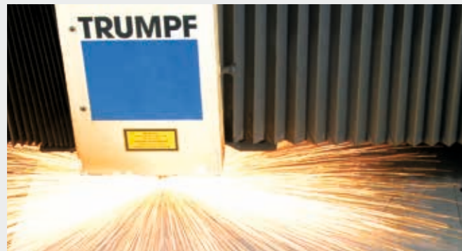
Каждая часть конструкции комбайна изготавливается на станках для лазерной резки, которые, начиная с трехмерного чертежа, позволяют изготавливать готовую деталь.
