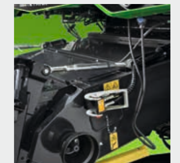
↑ Регулируемый угол среза для точного следования контурам неровной местности.
