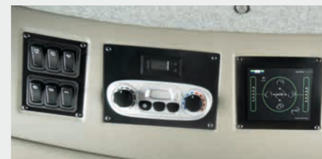
↑ Система Balance полностью автоматически регулирует положение всей машины, корректируя поперечные уклоны до 20% и продольные уклоны до 6% и удерживая комбайн в идеальном горизонтальном положении.
