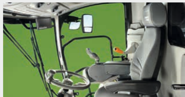
2) Эргономичное сиденье с механической или пневматической регулировкой и регулируемой рулевой колонкой для удобного положения водителя.
