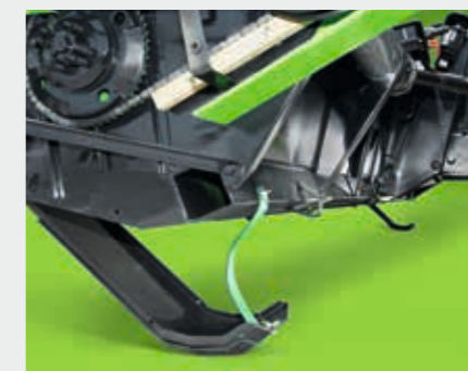
Сенсорные салазки позволяют жатке точно следовать контурам рельефа и мгновенно регулировать высоту работы.
