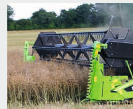
Набор для рапса может быть установлен на зерновую жатку для большей универсальности.
