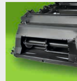
↑ Широко открывающийся канал наклонной камеры позволяет системе обмолота обрабатывать большие объемы урожая.
